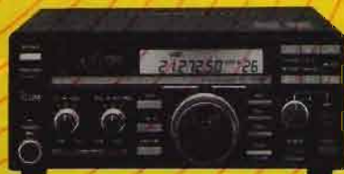
ICOM IC 725 - Ricetrasmittitore HF, compatibile a tutti i modi operativi, 26 memorie, compatto, modi AM, FM, SSB, 200 W/PeP, alim. 13,8 V Dc.
