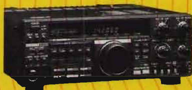
KENWOOD TS 440 AT - Ricetrasmittitore HF, da 100 kHz a 30 MHz, 200 W/PeP con accordatore d'antenna automatico all mode compatto e leggero. TX e RX continui da 1,8 a 30 MHz; modi AM, FM, SSB.
